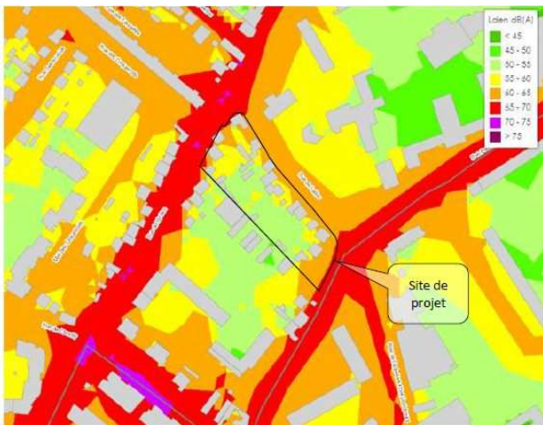
Illustration 6: Carte stratégique de bruit routier sur 24h (indicateur acoustique Lden) montrant que le site est exposé à des niveaux sonores pouvant atteindre 65dB (source Bruitparif).
