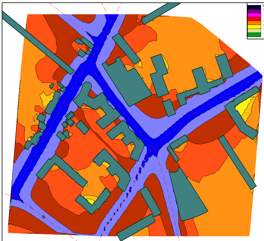
Projetée : Niveaux sonores L_{Aeq} , pour l'heure de pointe du matin, en dB(A)
