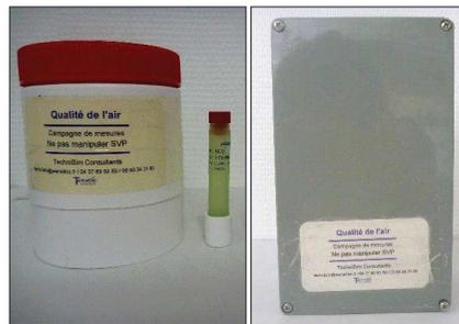
Figure 36 : Réceptacle, tube passif et micro-capteur laser
