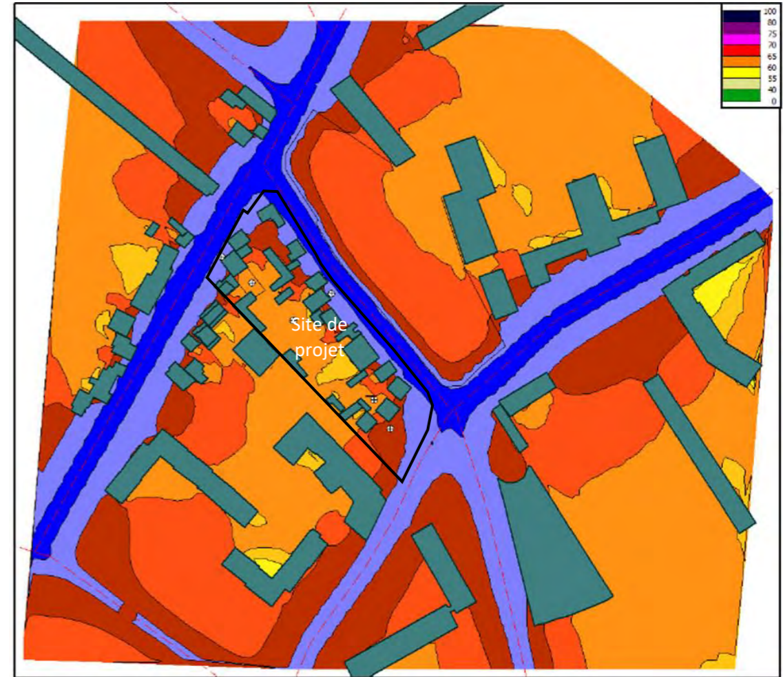
Cartographie sonore - Etat initial : Niveaux sonores L Aeq , pour l'heure de pointe du soir, en dB(A)
