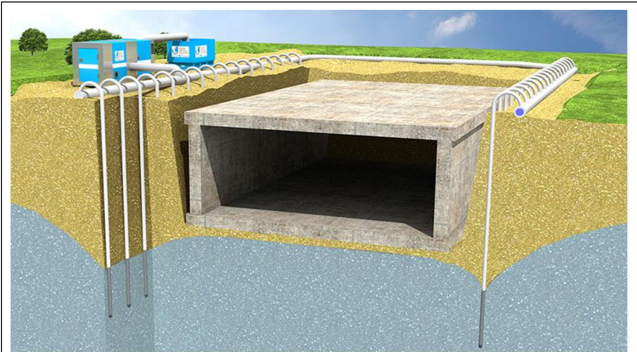
Figure 30 – Schéma de dispositif de pointes filtrantes (Source : https://www.dsl.fr/gestion-de-projet/rabattement-de-nappe/#principe )
